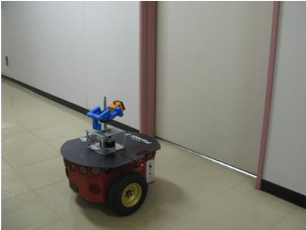
図 5.17: 実環境下の三次元測位の様子
