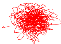
図 5.13: 飽和濃度食塩水における特徴的な水分子の挙動 (表示時間: 20ps、左右長さ: 1.3Å)
