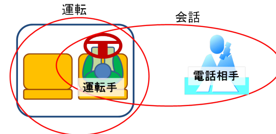
図 2 運転中の携帯電話使用時における認知フレームの多重化
