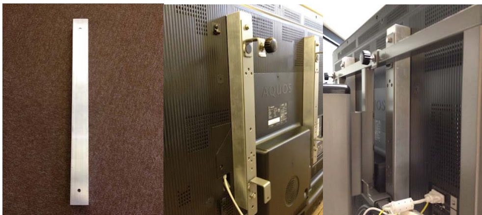
図 7. 制作したスペーサー (左)と実際に取り付けた様子
