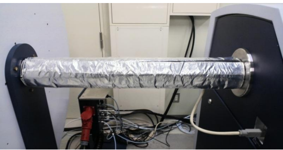
Fig. 24 サーマルジャケットの取り付け
