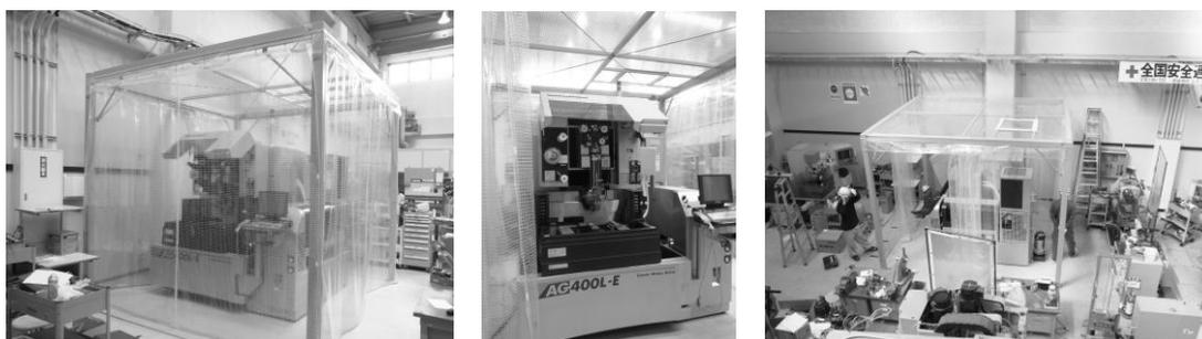
Fig 3 : 新 EDM 用防塵室外観
