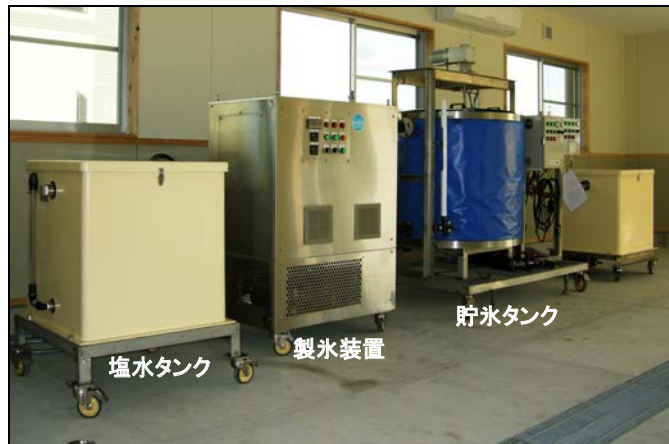
写真1 中土佐町に導入されたスラリーアイス製造システム（中土佐町鮮度保持研究施設）
