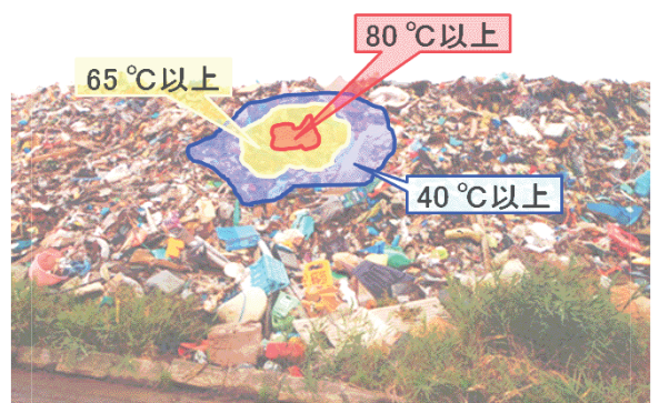
図6 危険温度区域のカラー表示(仙台市蒲生 ガレキ置き場)
