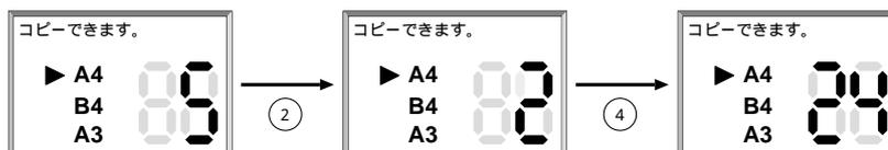
2. ひとたびテンキーの入力を始めたら、数字キーを1度押すたびに1桁ずつ右端に表示され、1回前の入力値は1桁左へ送られて表示される。これで2桁の数値を表す。
