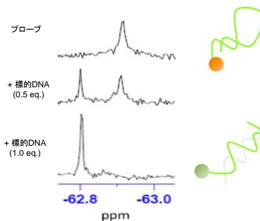
図5 ケミカルシフトレシオ変化型プローブに標的DNAを添加したときの<sup>19</sup>F NMRケミカルシフトの変化
