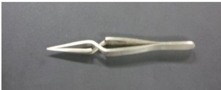
図 12. 実験に使用したネガティブピンセット
