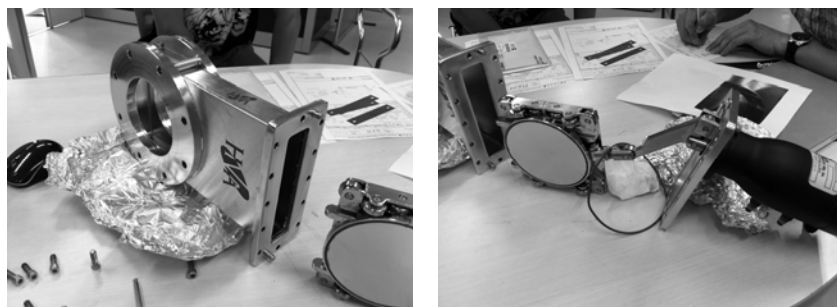
図 3.ゲートバルブ修理
