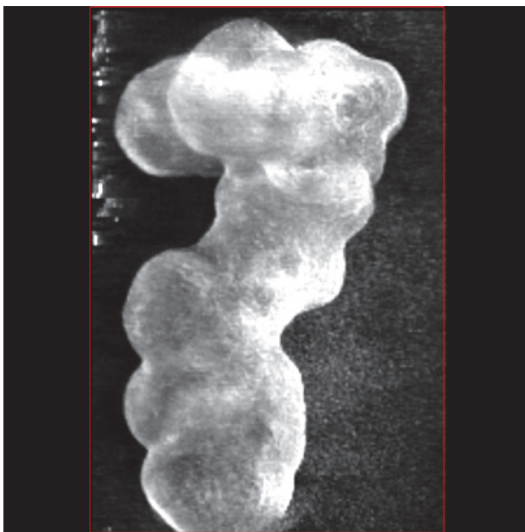
図 5 ケッチェンブラックの TBR 法による再構成結果
