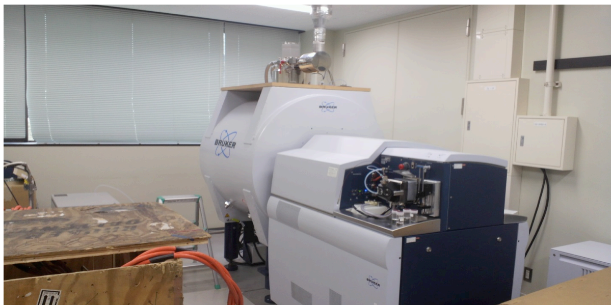
Fig. 3 消磁準備中の 9.4T FT-ICR MS (Solarix-JA)
