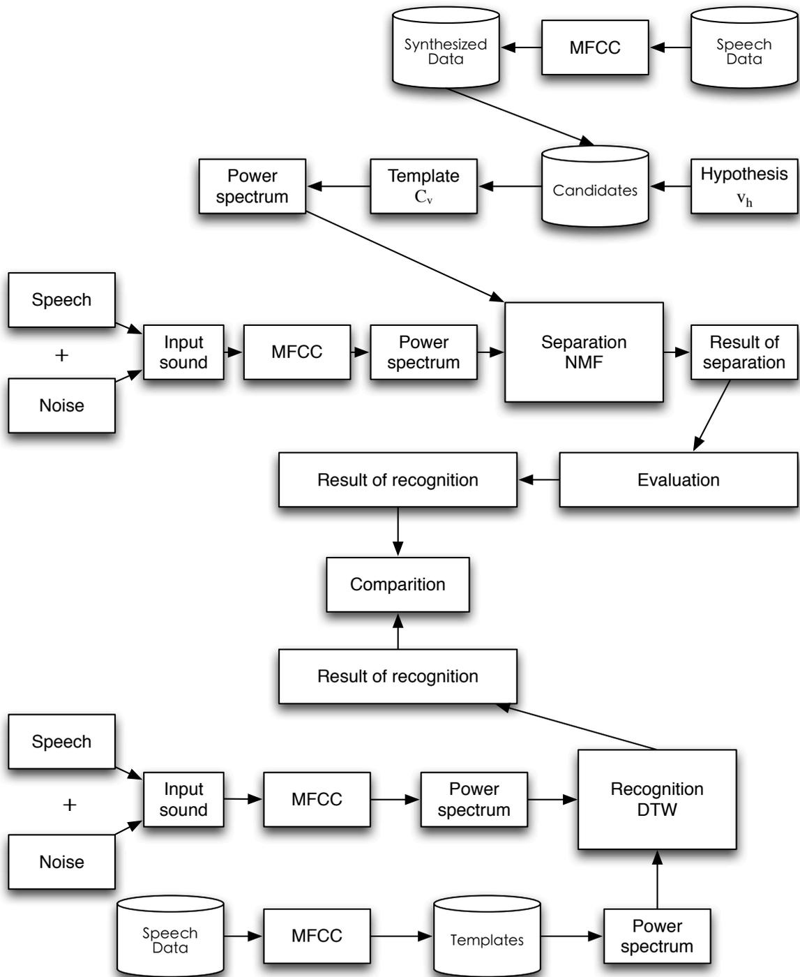
図 4.1: 比較実験のデータフロー
