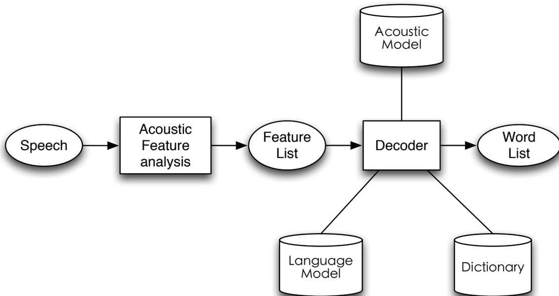
図 1.1: 音声認識システムの概要
