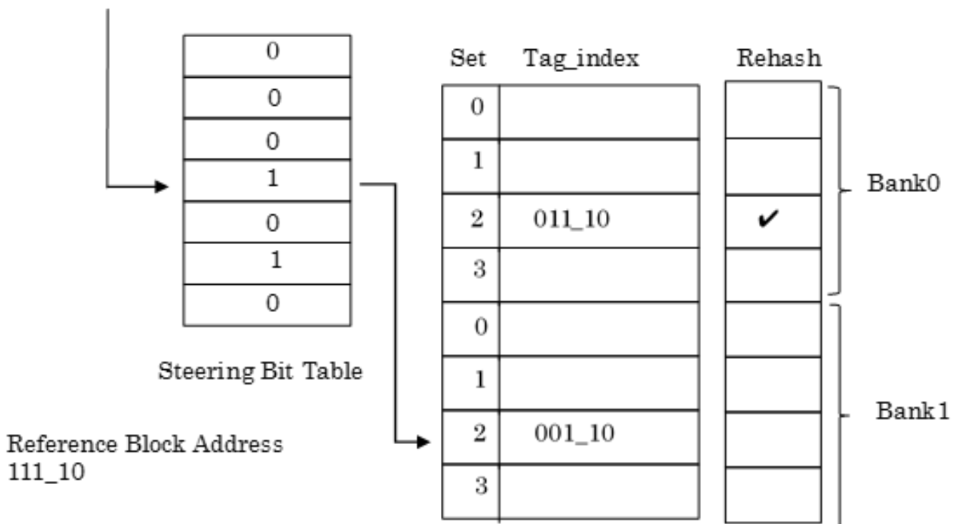
図 2.1: ブロックアドレス 110_10 を参照する際の PSA の振る舞い. まず, Prediction Address をインデックスとして Steering Bit Table のエントリーを参照し, そのエントリーを用いて Bank1 のセットを限定参照 (probe0) している. Bank1 の参照の際に Bank0 の対応するセットの Rehash Table を参照し, Rehash 値が有効となっているため Bank0 への probe1 を行う. しかしながら, Bank0 への probe1 はキャッシュミスとなり, LRU 管理によってブロックを置き換える.
