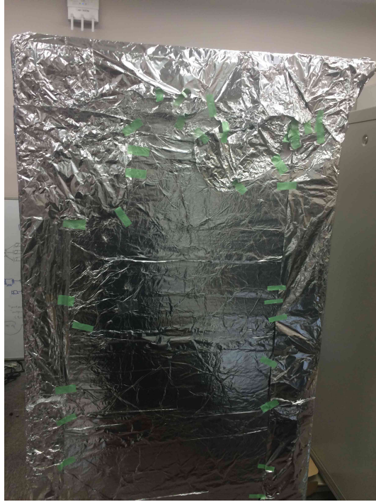
図 5.12: アルミ箔による電波遮蔽ラック画像 1
