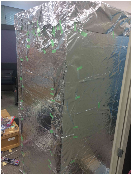
図 5.13: アルミ箔による電波遮蔽ラック画像 2
