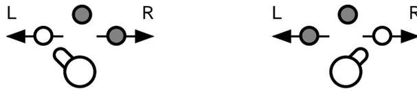
図 5.7: 乙駅の方でてこを R に転換した時の方向でこの状態
