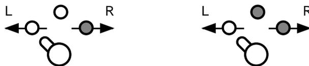
図 5.6: 乙駅の進行信号てこを定位に戻した時の方向てこの状態
