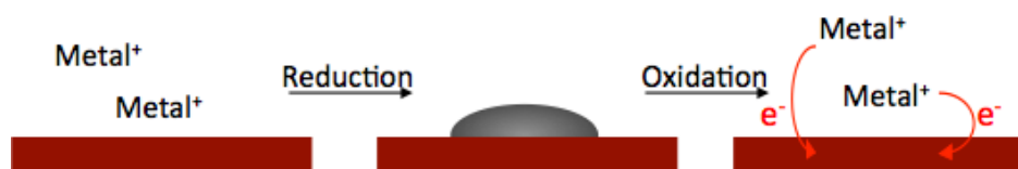
図 4 アノードックストリッピングボルタンメトリー (ASV) の概略図
