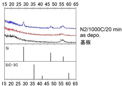
図 8. SiC-ink による SiC 膜の XRD 分析結果
