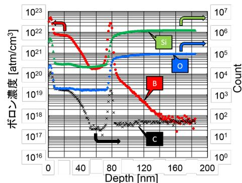
図 7. SiC-ink による p 型 SiC 膜の膜中不純物分析結果 (SIMS 分析)
