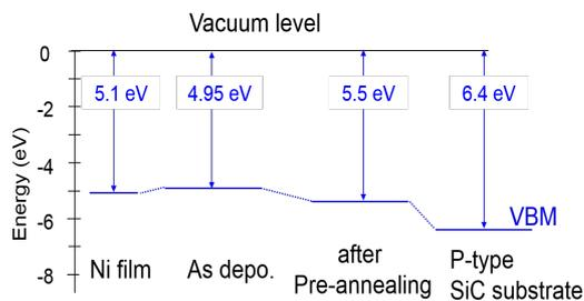
図 5. PYS による Ni の仕事関数、SiC 基板の VBM、SiC 膜 (C<sub>film</sub>=0.2) の VBM (as depo. 膜とアニール後の膜) 評価結果
