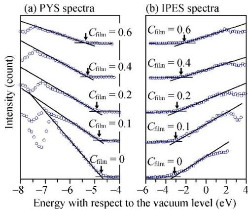
図 4. SiC 膜の CBM, VBM 評価結果
