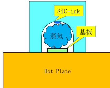
図 3. LVD 法による SiC 膜の成膜
