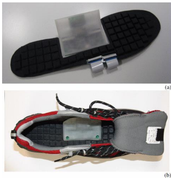
図 2.12 圧力センサを用いた歩様解析システムを内蔵した靴[37]
