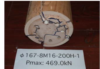
図-8 ブロック抜け
