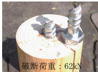
図-7 ラグの破断
