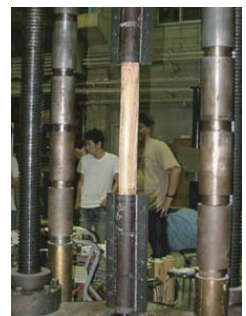
図-2 実大引張り実験
