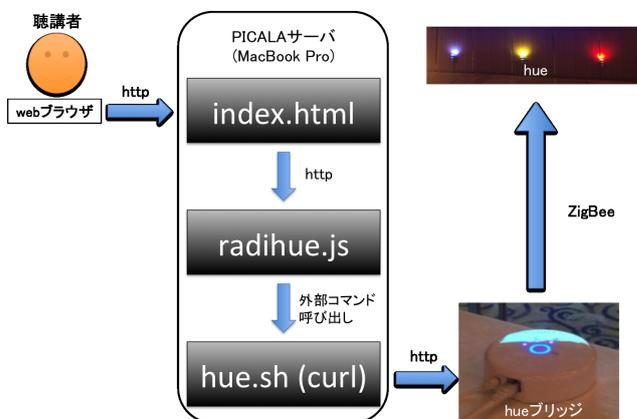
図 2 PICALA のシステム構成図
