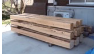
写真-4 栈積み乾燥試験
