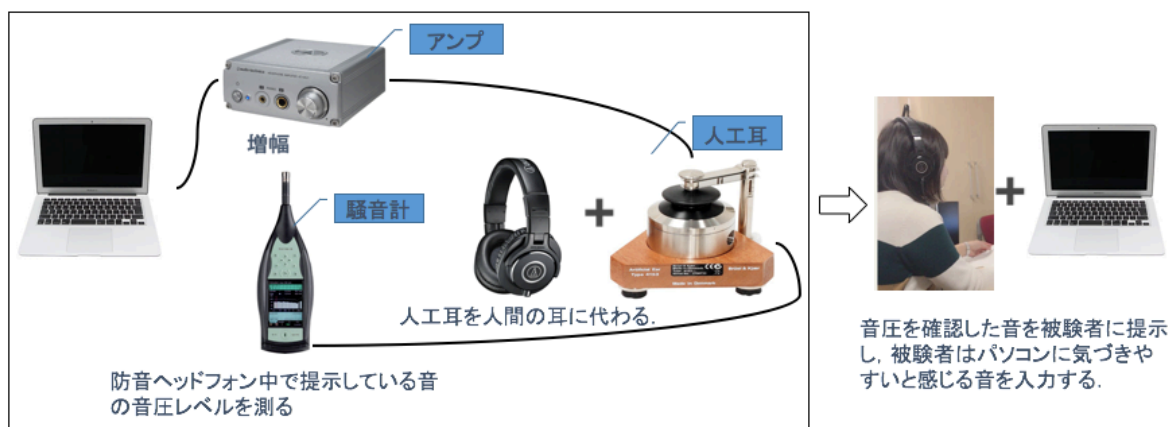
図 13 音声特性実験での機器接続画像
