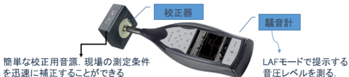
図 12 騒音計 TYPE 2250, 校正器 TYPE 4231 画像
