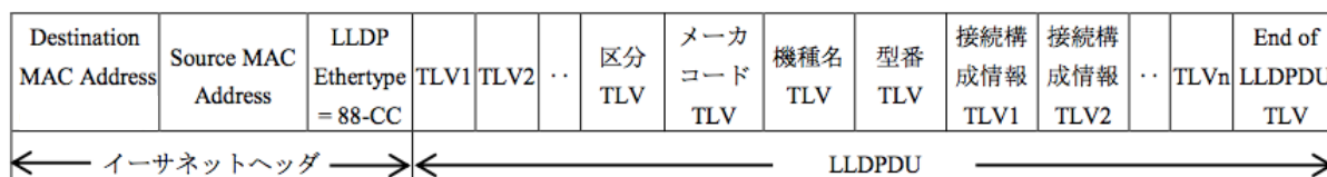
図 3.3: LLDPDU フレーム構成
