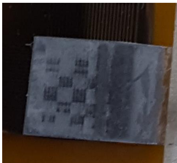
図 7.9 液体プロセスにより作製した低温酸化物 TFT を駆動素子として動作した電気泳動ディスプレイのチェッカーパターン表示時の写真
