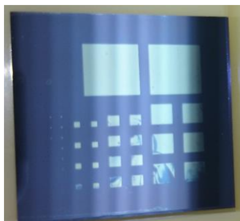
図 6.6 InO ゲルのパターニングと同様の条件で行った InGaO ゲルのパターニング結果
