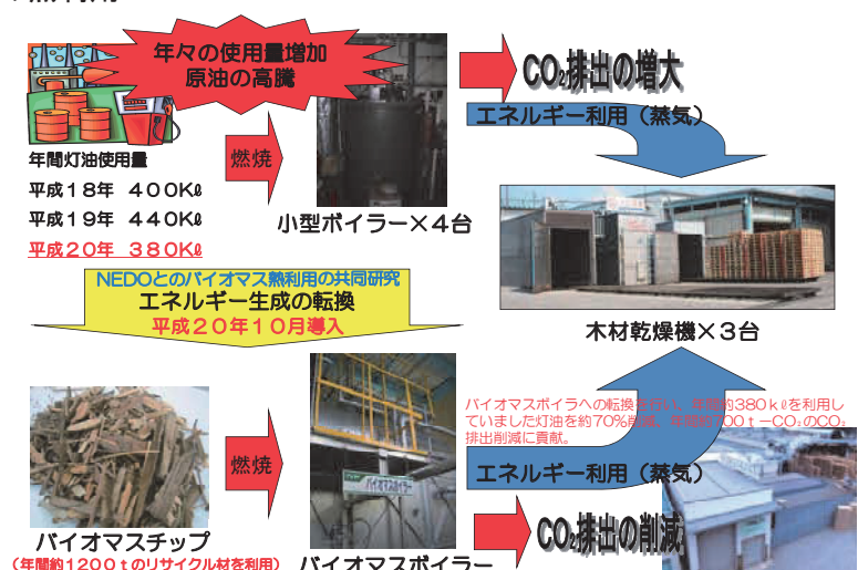
図1 灯油ボイラーを木質バイオマスボイラーへ転換
