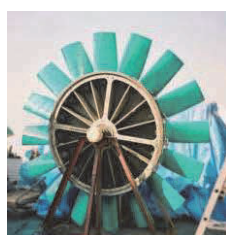
トンネル排気扇
