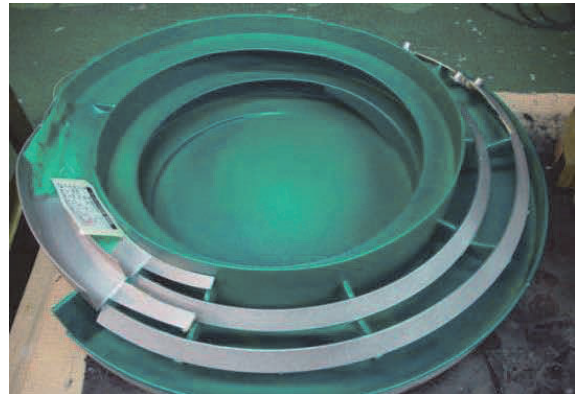
図4. ポリウレタン塗装したパーツフィーダ
