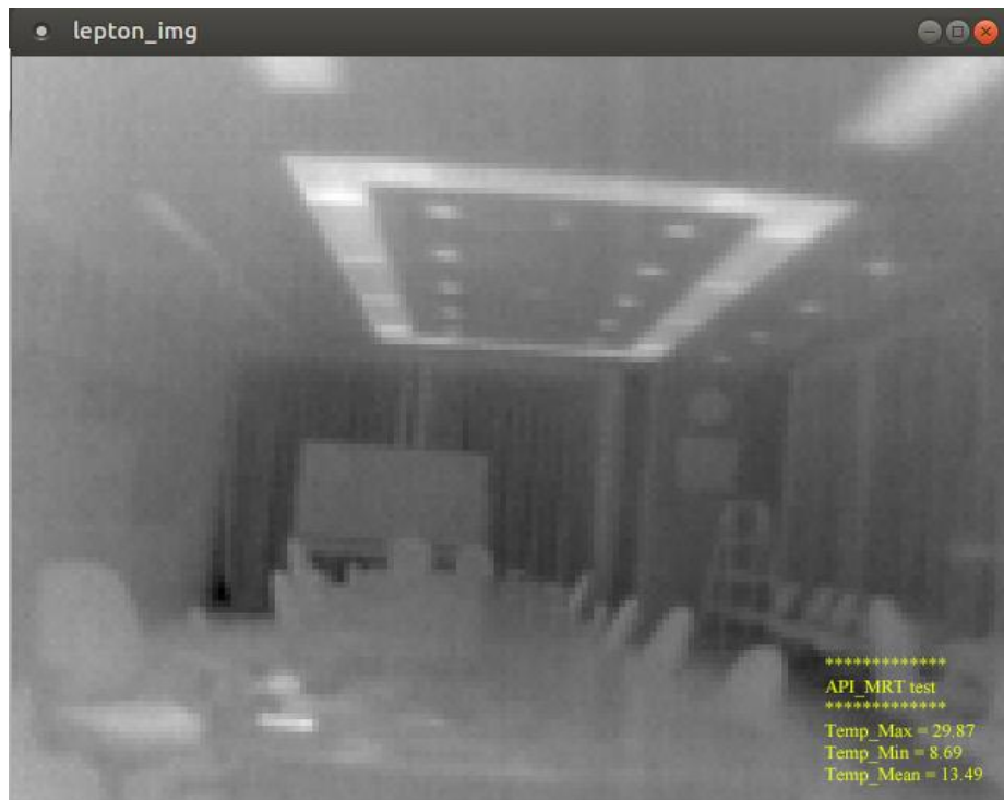
図 6-14 環境の平均輻射温度を計測様子
