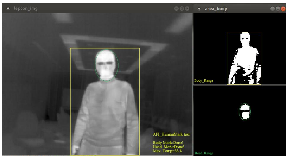
図 6-6 実験結果 人間識別 API 動作確認 I (Body、Head 識別成功)
