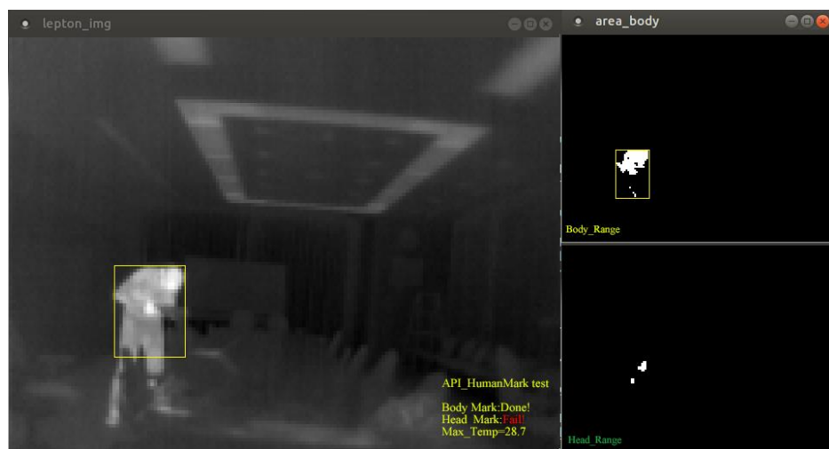
図 6-7 実験結果 人間識別 API 動作確認 II (Body 成功 Head 失敗)
