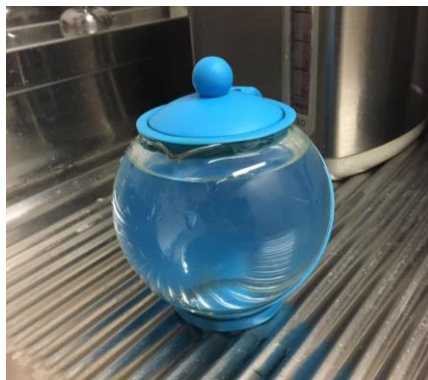
図 6-4 異常発熱家電をシミュレートする熱湯を積んだ水筒
