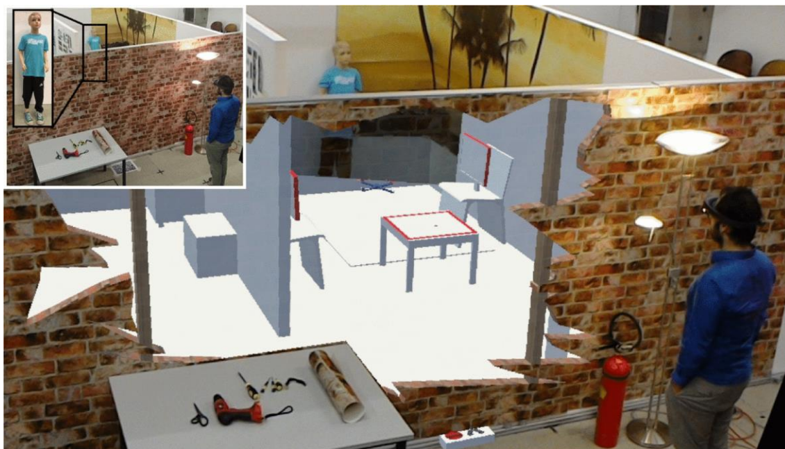
図 4 頭部装着ディスプレイで 3D 空間を視認しながら操縦する
