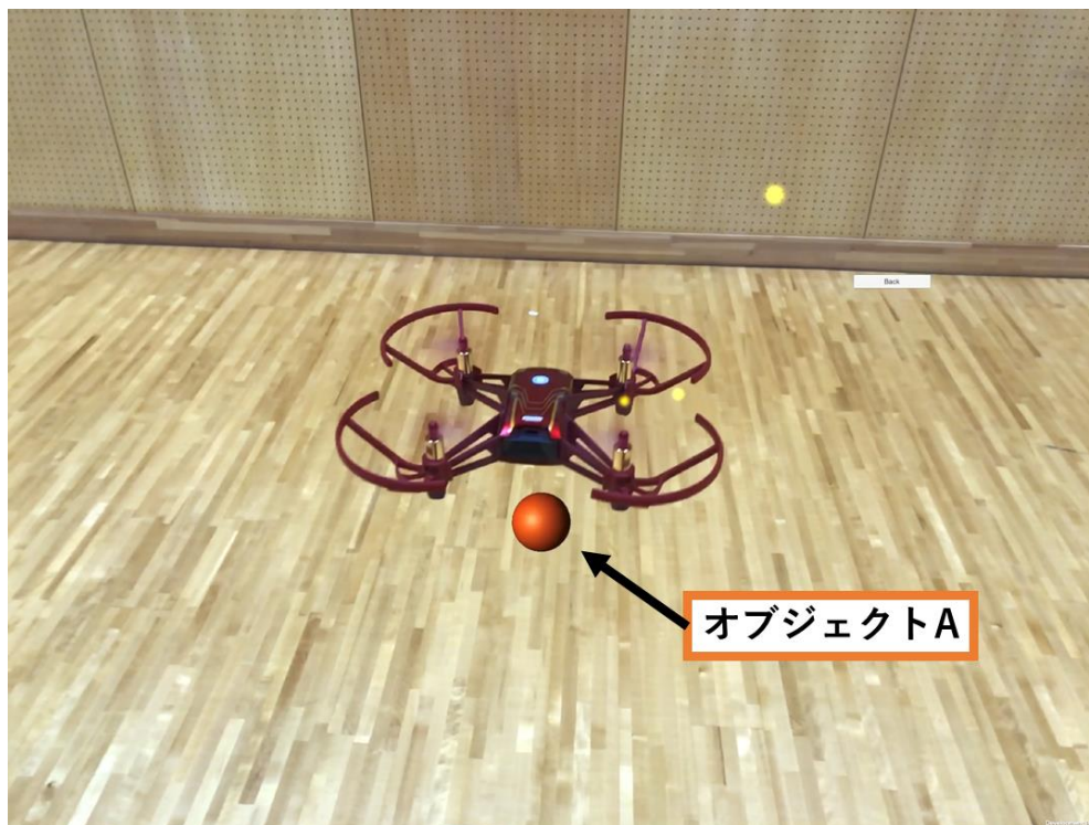
図 13 ドローンを物体認識した位置にオブジェクト A を表示する。 (黄色い点は ARKit がカメラ映像から認識した特徴点)
