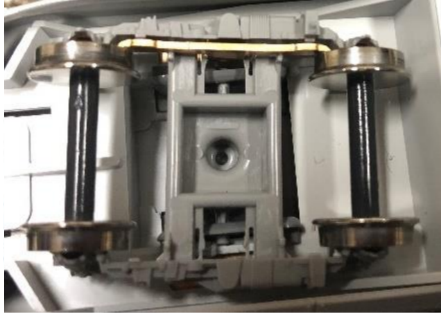
図 3.2: 正常状態の車輪 [21]
