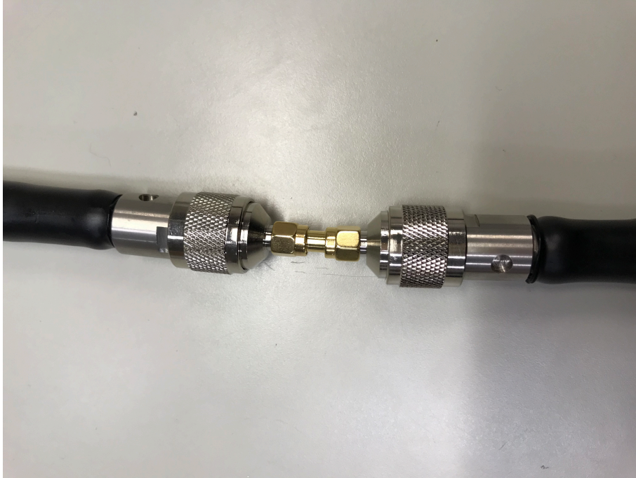
図 4.7: N 型-SMA 型変換コネクタの測定
