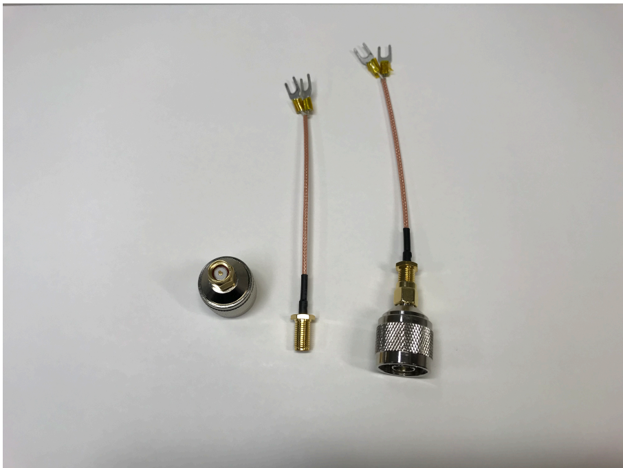
図 4.8: 製作したケーブル付きの N 型-SMA 型変換コネクタ
