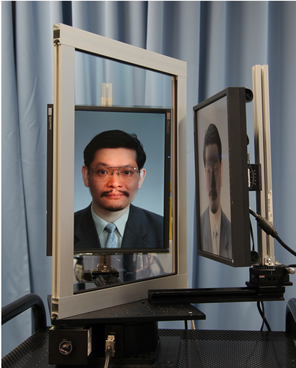
図 5.7 基礎実験用の評価機へ実験用画像を表示した時の様子
