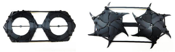
図3：服に取り付けた気孔部が開閉する様子
