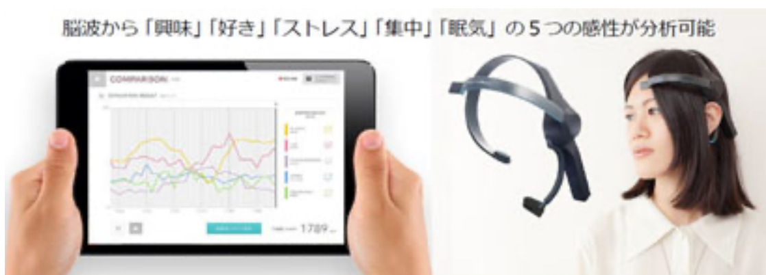
図 4 感性アナライザ[7] 左:取得した脳波をディスプレイ表示 右:本体
