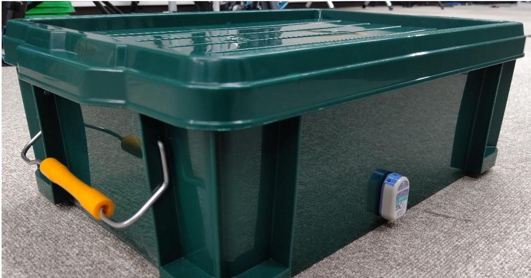
図 4 加速度センサ取り付け位置
