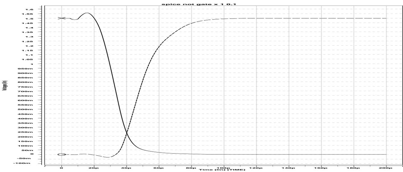
図 3.6: インバータ入力 1 = 0、出力側のゲート容量は 1 負荷
