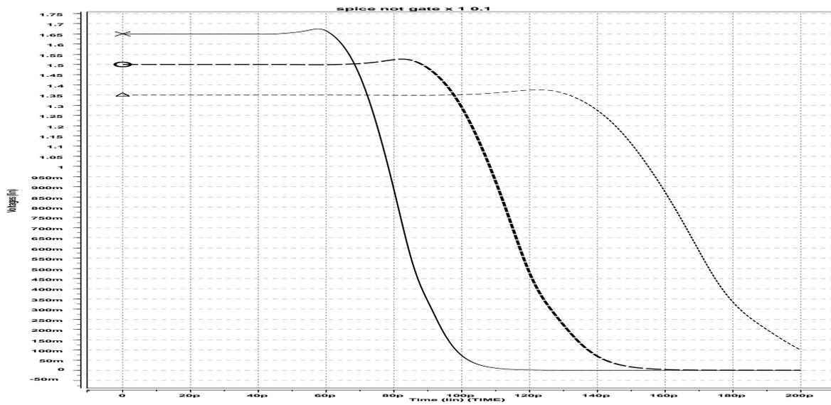
図 5.3: 一段バッファの正常条件と最悪条件と最良条件の評価
