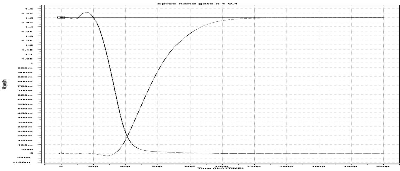
図 3.11: nand 入力 A(1 0) B(1)、出力側のゲート容量は 1 負荷
