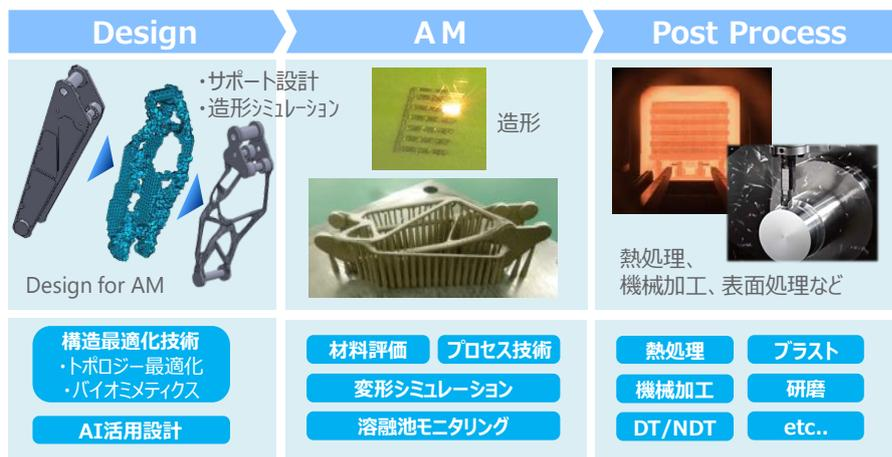
図 1 金属 AM の設計・製造プロセスと関連技術
