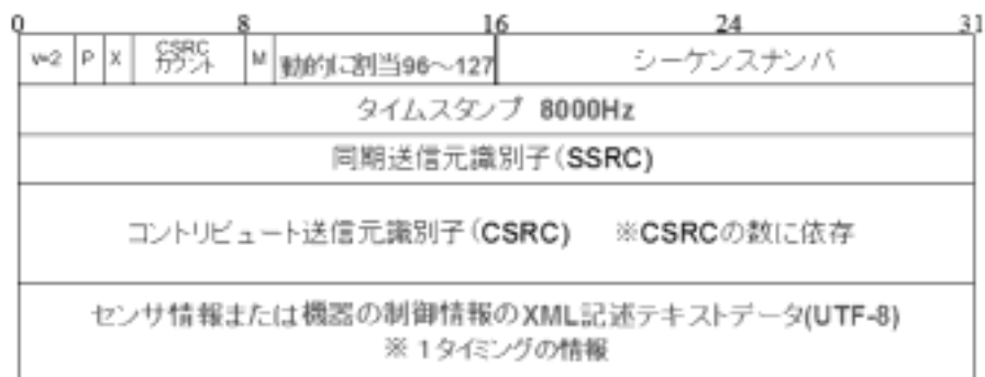
図 4.5: 新たに提案するテキストデータストリーミングの RTP パケットの内容
