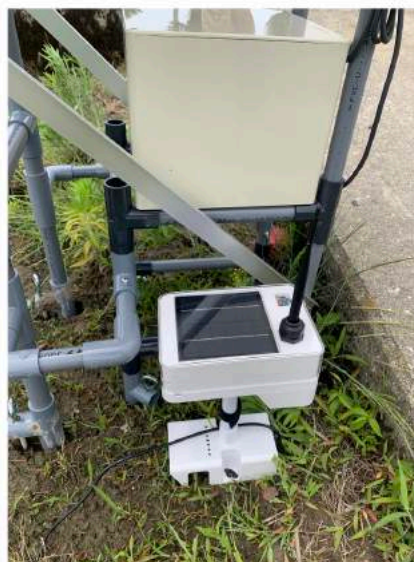
露地ファーモ(気温, 地中温度, 照度, 土壤水分, EC)
