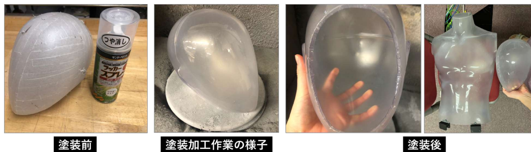
Figure 4.11: 頭部型ディスプレイへの塗装
