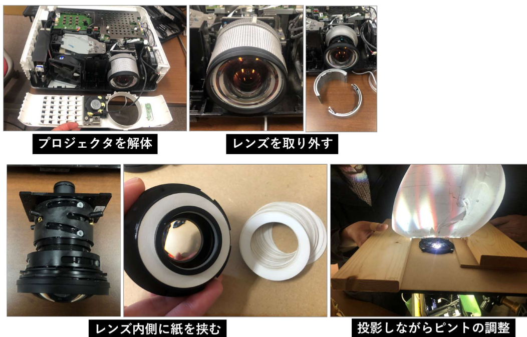
Figure 4.19: 魚眼レンズのピントを合わせる作業
