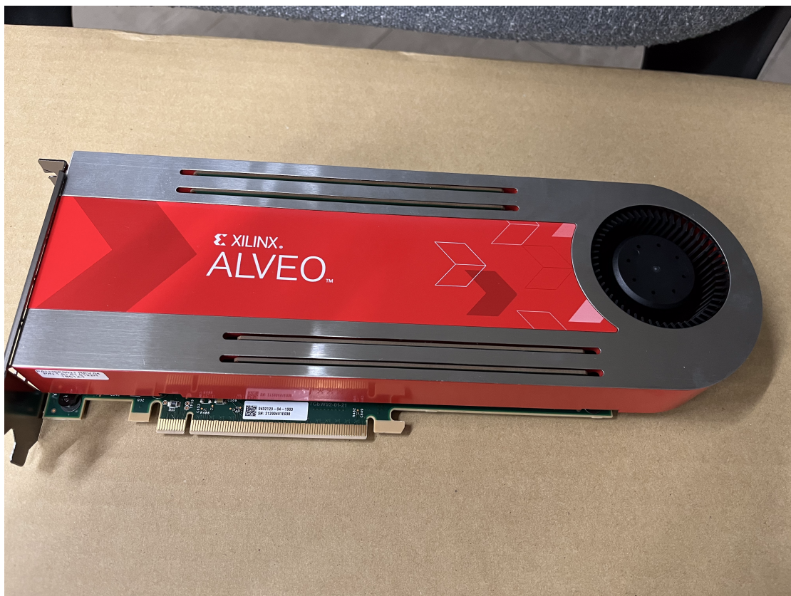
図 2.12: 評価に用いた Alveo U200 データセンターアクセラレータカード
