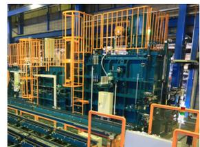
図 1.最新型真空浸炭炉
