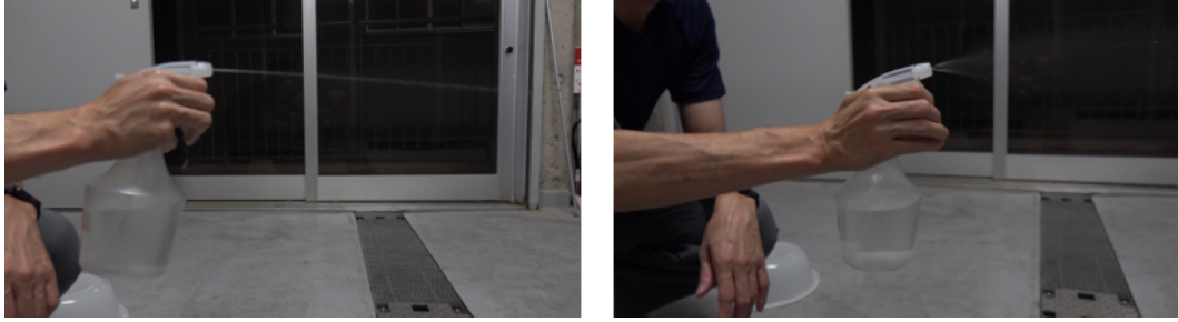
図 4.9: 霧吹きによる放水, 左からストレート・フォグ放水状況
