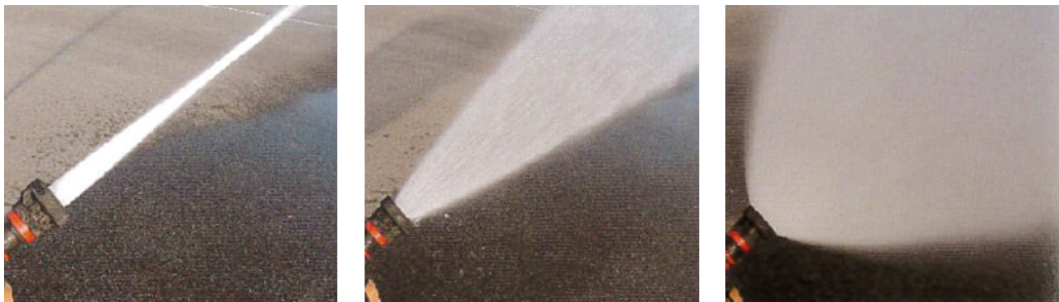
図 4.8: 左からストレート・スプレー・フォグ放水状況
