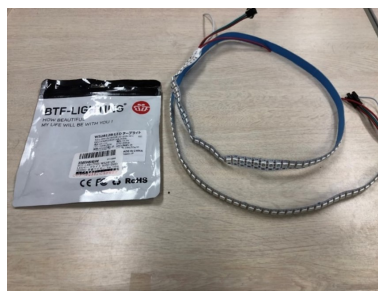
図 5.5: 使用したLEDテープ (WS2812B)
