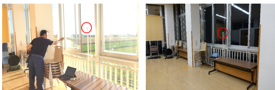
図 5.29: 開放する窓と湿度センサの距離 20cm の時の様子
