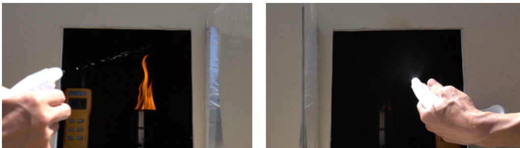
図 4.10: ストレート (左), フォグ (右) の放水状況
