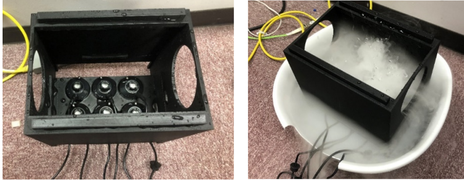
図 5.3: 下部ディスプレイに設定した超音波霧発生装置と作動状況
