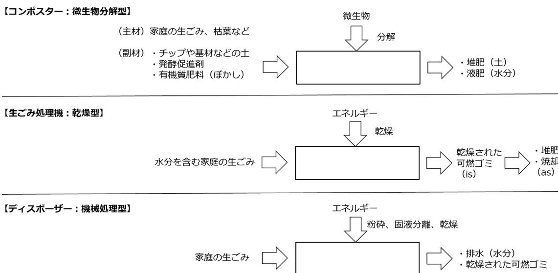
微生物分解型であるコンポスターでは、インプットの主材は家庭における生ごみや庭木の枯葉・落ち葉である。副材として、チップや土、発酵促進剤、有機肥料などを入れ、微生物が活性化する環境を整える。システム内部では微生物による分解があり、アウトプットとして堆肥として利用できる土、液肥として利用できる水分が排出される。
