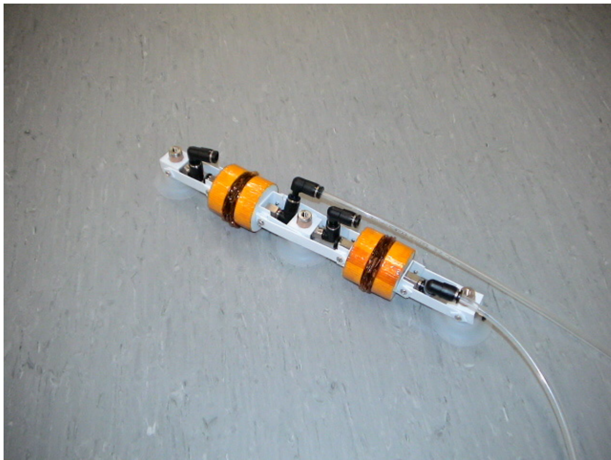
図 4.21: 製作したミミズ型ロボットの縮んだ状態
