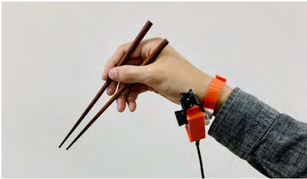
図 1: 手首装着型カメラデバイス Fig. 1 Wristband device with a camera
