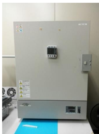
図 2-12 アニール炉の外観
