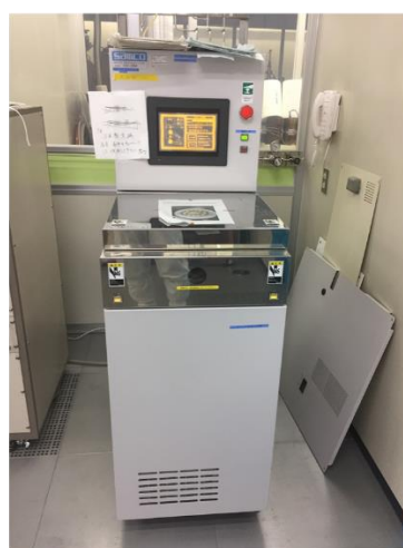
図 2-2 RIE の概略図 (左) と外観 (右)
