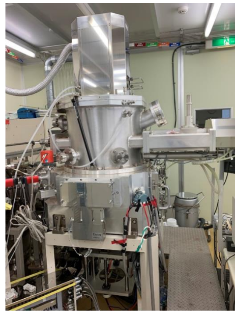
図 2-4 Cat-CVD (SI 機) の概略図 (左) と外観 (右)
