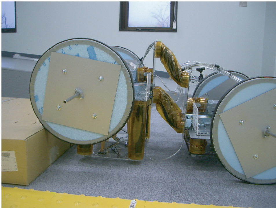
(b) Step 2 / 9 : フロントジャッキアップ
