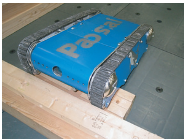
(b) UMRS-M2 (おもりによる重心移動を利用した瓦礫踏破機構装備)
