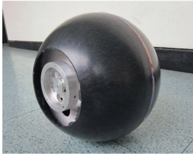
(a) 重心移動による姿勢制御研究用の全球ロボット [26]
