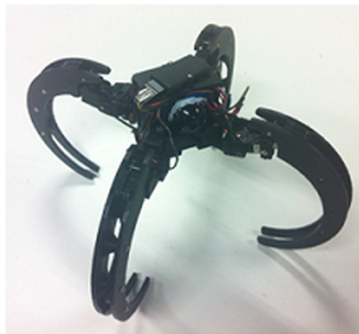
(c) Scorpio[28]、車輪蜘蛛から着想を得たバイオニクスロボット
