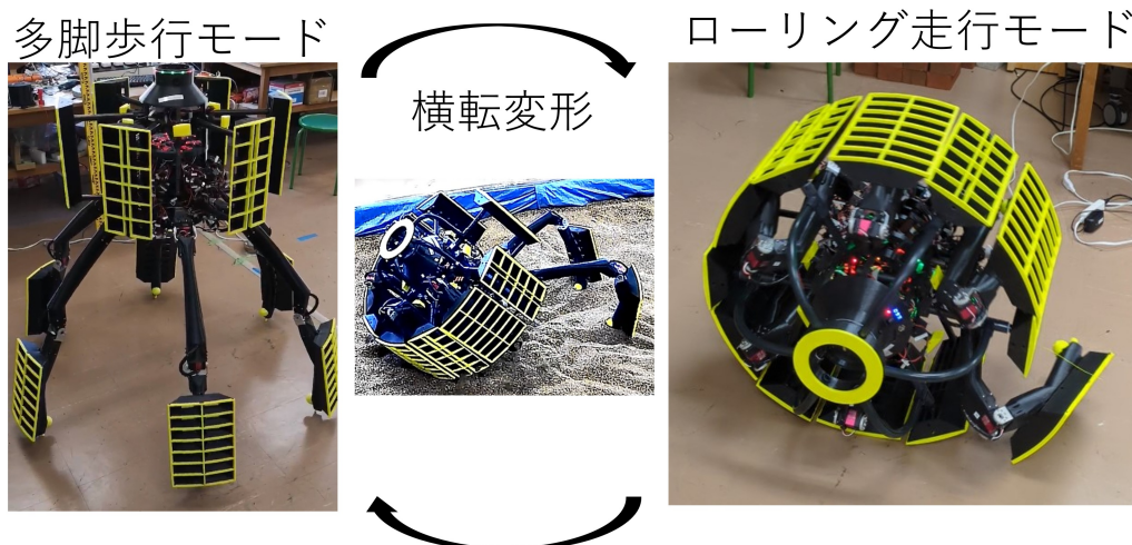
図 1.1: Rollopod-A の多脚歩行モードとローリング走行モード
