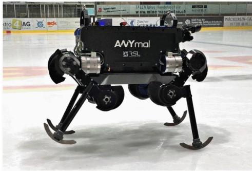
(a) ANYmal にアイススケータを用いたスイングロコモーション研究 [22]
