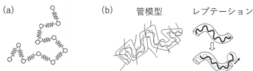
Figure 3-3. (a)ラウズ緩和モデル, (b)レプテーション緩和モデルとレプテーション運動 4)
